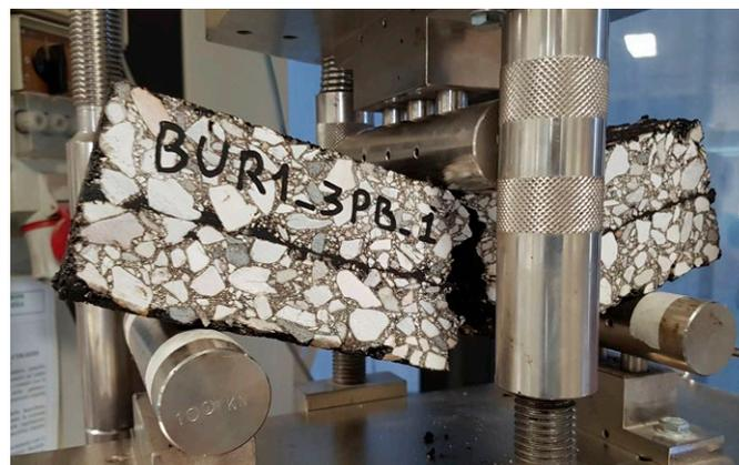
Le prove di flessione statica su tre punti **3PB** -Three Point Bending- sono prove per l'analisi della resistenza a flessione del sistema bistrato, realizzate su provini prismatici di dimensioni standardizzate (30,5x8,5x8 cm) a velocità e temperatura di prova costanti (i.e. 50.8 mm/min; 20 °C). **Tale prova è stata eseguita per la valutazione della resistenza del sistema alla fessurazione provocata dai carichi flessionali indotti dal peso dei veicoli transitanti sulla pavimentazione.**
