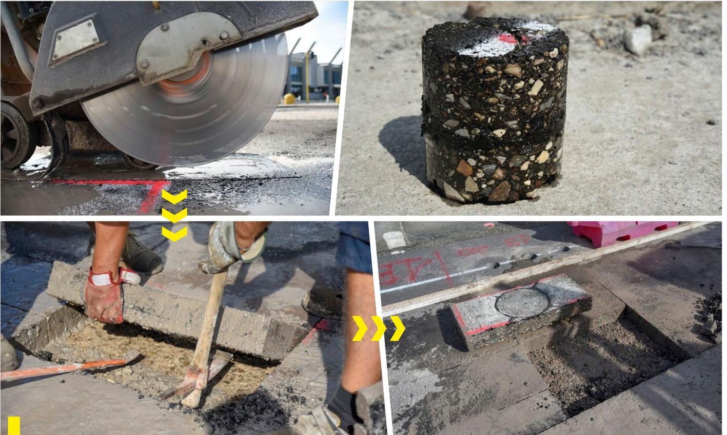
Prelevamento di campioni sotto forma di carote e lastre bistrato per l'esecuzione del successivo programma sperimentale di laboratorio.
