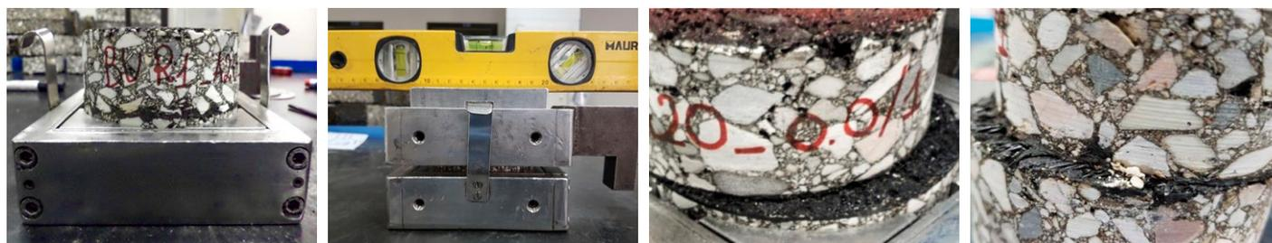
La prova di resistenza a taglio dell'interfaccia viene realizzata su provini cilindrici (diametro: 95 mm) a velocità controllata (i.e. 2.5 mm/min), due temperature di condizionamento dei provini (i.e. 20 e 40 °C) con valori differenti di sforzo normale applicato durante l'esecuzione del test.
