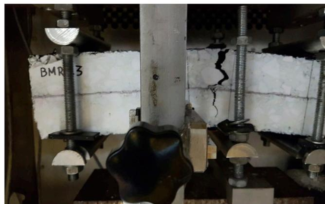
Le prove di flessione dinamica su quattro punti **4PB-Four Point Bending**- sono **prove per la valutazione della resistenza alla fessurazione da fatica negli strati legati indotta dal passaggio ciclico dei veicoli sulla pavimentazione**; vengono realizzate a frequenza, carico verticale e temperatura di prova costanti (i.e. 1 Hz; 1.6 kN; 20 °C) su provini prismatici (30,5x8,5x8 cm).
