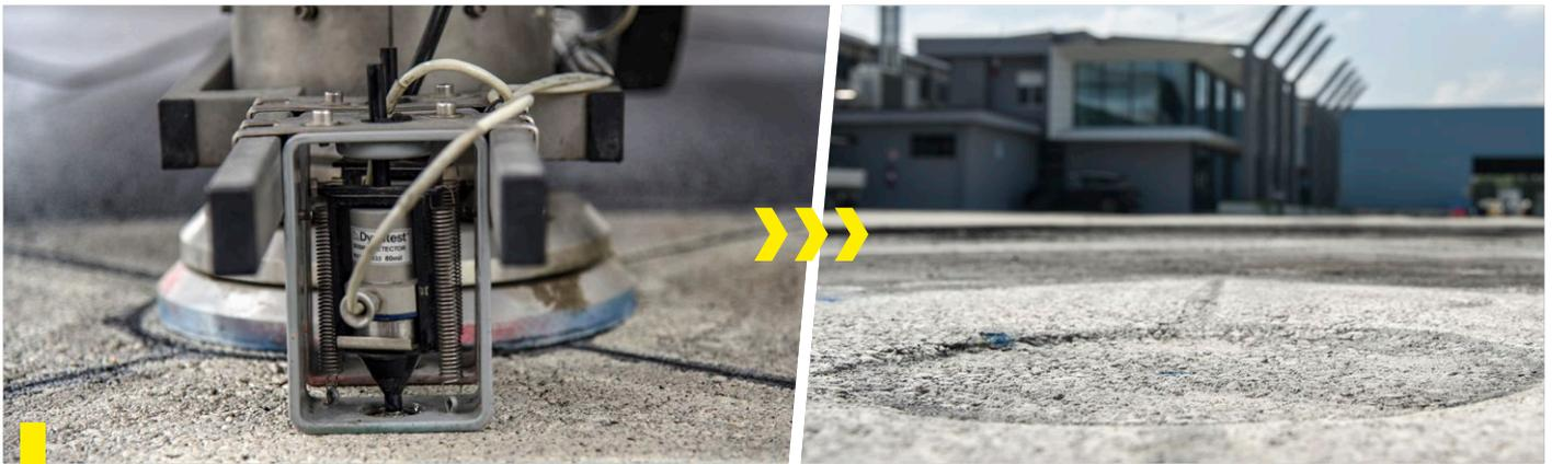
Prove di carico accelerate (**Accelerated Pavement Testing - APT**) effettuate mediante apparecchiatura **Fast Falling Weight Deflectometer (FFWD)**.
