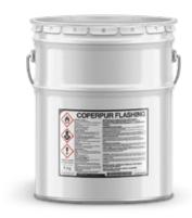
Membrana liquida monocomponente poliuretano-bituminosa tixotropica, a rapida vulcanizzazione. Il materiale vulcanizza con l'umidità atmosferica. Subito fuori pioggia.
