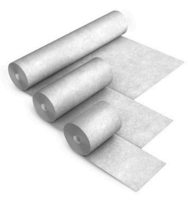
POLY-RINFORZO è un tessuto non tessuto in poliestere da fiocco, colore bianco, coesionato mediante agugliatura, senza resine, collanti, calandrato su un lato. POLY-RINFORZO, oltre alle eccellenti prestazioni ed all'elevata tenacità in lavorazione, trasferisce ottime proprietà alle impermeabilizzazioni eseguite in sito, assicurando una miglior stabilità e durabilità, resistenza e nello stesso tempo eliminando il fastidioso fenomeno della memoria termica.
