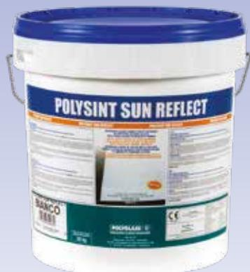
**POLYSINT SUN REFLECT** è una membrana liquida acrilica fibrata in emulsione acquosa di colore bianco, ad alta riflettanza solare (83%) ed emissività termica (91%) con indice di riflessione solare (SRI) 105 per la protezione di membrane impermeabili bituminose e superfici in calcestruzzo.
